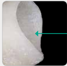
Strat de reacție: Strat hibrid compus din masa de ambalat și material presat
