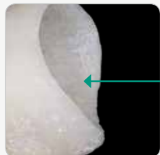
Strato di reazione: strato ibrido composto da rivestimento o materiale pressabile
