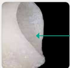
Reakční vrstva: hybridní vrstva sestávající z litího a presovacího materiálu
