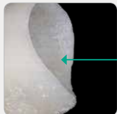
Reakcijski sloj: Hibridni sloj sačinjen od materijala za ulaganje i prešanje
