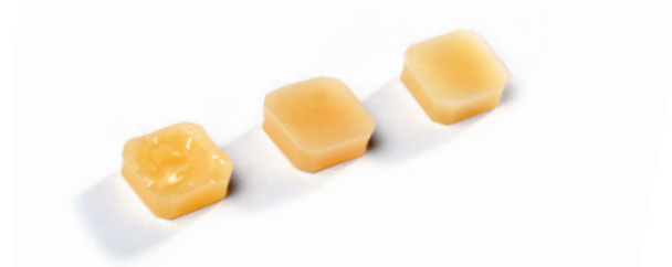
Grado di lucentezza del composito non lucidato. Il campione di sinistra è realizzato con G-ænial Universal Flo.
